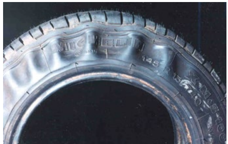
Eksempel: dekk som har vært i kontakt med hydrokarboner.
